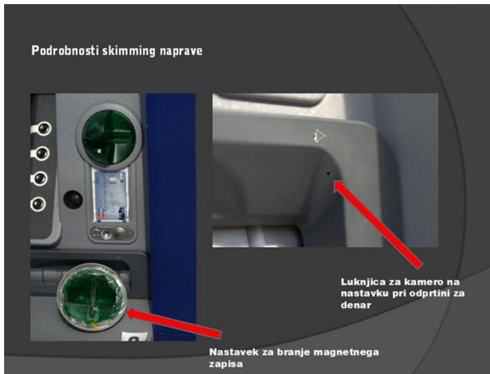
Slika 1: Skimming naprava najdena na bankomatu v Sloveniji (Vir: Skimming, 2011)
